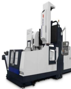
◆ **全体機械**：機械は門型フレームを固定し、作業台が移動する構造です。基盤の大部分は高品質な樹脂砂型と高強度鋳鉄材料で鋳造されており、機械に高い剛性と安定した精度を提供します。主要な鋳造部品はすべて有限要素解析を経ており、リブの配置が合理的で、機械が高トルクの切削要求を十分に満たすようになっています。
